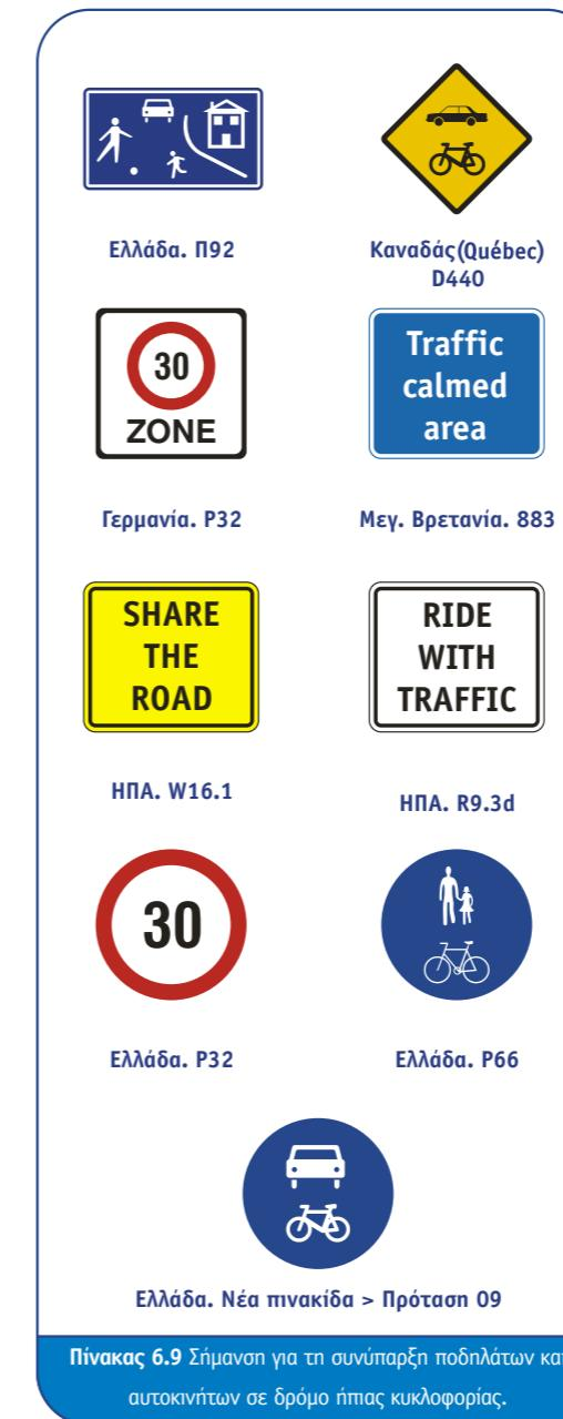
Πίνακας 6.9 Σήμανση για τη συνύπαρξη ποδηλάτων και αυτοκινήτων σε δρόμο ήπας κυκλοφορίας.
