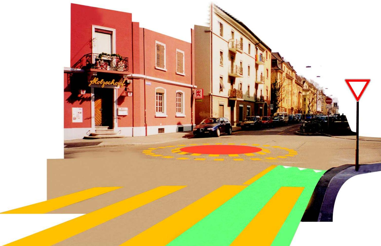
**Συρίγη. Η κυκλική διαγράμμιση σε συνδυασμό με την ελαφρά υπερύψωση επισημαίνει στους οδηγούς αυτοκινήτων τη διασταύρωση ώστε να μειώνουν ταχύτητα για το πρόσθετο λόγο ότι από αυτήν διέρχεται λωρίδα ποδηλάτου**
